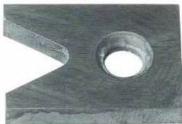
Cuchilla D82 para soporte tipo D. Reversible de metal duro integral. Para desbarbar chapas de hasta 8mm. Corte por ambas caras.
