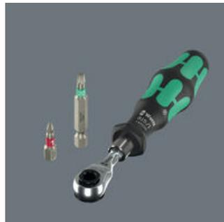
Por medio de su conexión hexagonal exterior de 1/4", la carraca de puntas Zyklop 8011 puede utilizarse para la toma hexagonal interior de 1/4" del porta-puntas 815/1. La carraca de puntas Zyklop es adecuada para puntas de 1/4".
