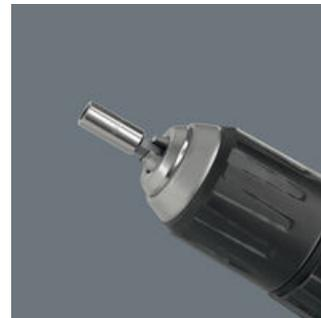
Un porta-puntas universal para la toma de puntas con arrastre hexagonal exterior de 1/4". El manguito de acero inoxidable ofrece una protección anticorrosiva especial. El anillo elástico garantiza un alojamiento óptimo de la herramienta dentro del porta-puntas. El fuerte imán permanente sostiene las puntas de manera supersegura. Adecuado para máquinas atornilladoras con toma según DIN ISO 1173-F 6,3.
