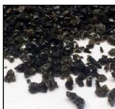
Silicato de Aluminio en granulado procedente de cámara de combustión, lavado, secado y clasificado. Exento de polvo y metales. Color marrón/negro. Formas irregulares, la mayoría angulosas. Adecuado para trabajos en seco y húmedo.
