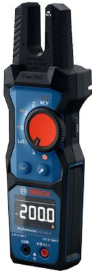
Horquilla amperimétrica de valor eficaz verdadero (True RMS) fiable y robusta con pantalla LCD invertida para comprobaciones rápidas de la corriente alterna
