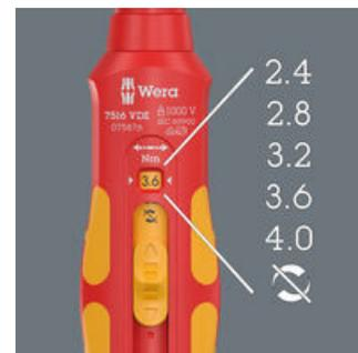
Cinco pares de apriete elegibles (2,4; 2,8; 3,2; 3,6; 4,0 Nm) y una posición fija (Torque Lock) para pares de apriete y desapriete ilimitados.
