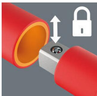
La toma de cuadradillo del mango en T dispone de un bloqueo por bola. El bloqueo por bola garantiza un alojamiento seguro de la herramienta insertada en la varilla. Al mismo tiempo permite un cambio rápido de la herramienta.
